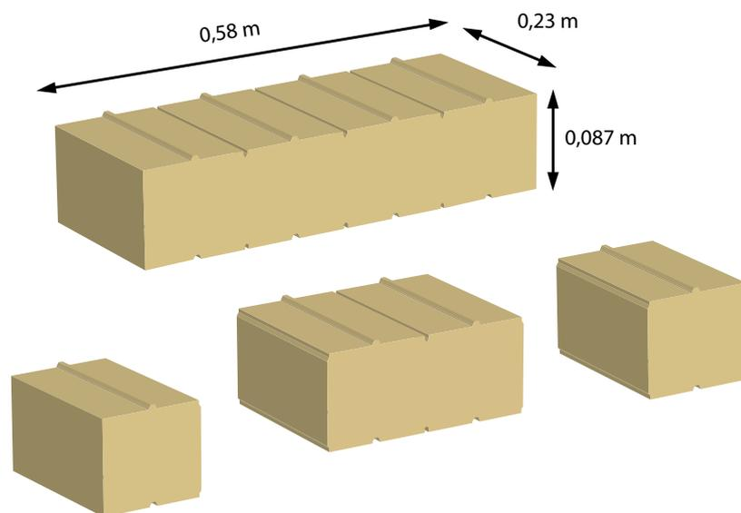
L'élément entier se coupe facilement, manuellement, et permet de réaliser deux éléments de 0,29 m et deux éléments de 0,145 m. Il peut être également utilisé dans toute sa longueur.
